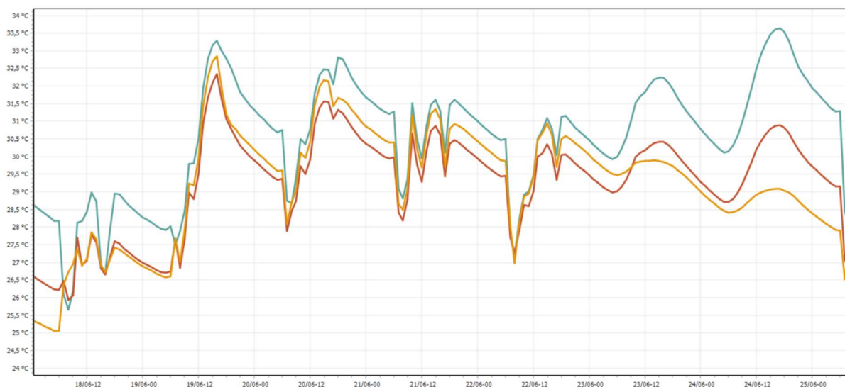
Figure 6 : Evolution de la température intérieure de 3 simulations (Sans protections - bleue / Vitrage contrôle solaire verrières - orange / Stores intérieurs verrières - jaune )
